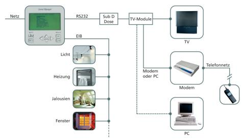
Elektrisch angetriebene Jalousien und Rollläden können sowohl einzeln als auch in Gruppen, dezentral und zentral, geschlossen als auch automatisch in Zwischenstellung gefahren werden.
